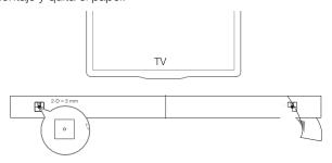
Atornilla los soportes para montaje mural sobre la marca del bolígrafo. Atornilla el poste de montaje con rosca en la parte posterior de la barra de sonido y, a continuación, cuelga la barra de sonido en la pared.
