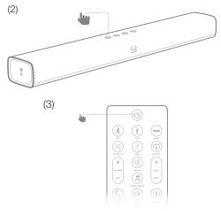
Sigue el mismo procedimiento para VOLUME- (Volumen -) y VOLUME+ (Volumen +). Para silenciar, pulsa a la vez los botones VOLUME+ y VOLUME- de la barra de sonido y el botón MUTE del control remoto del televisor. Mantén pulsados los botones VOLUME+ y SOURCE de la barra de sonido de nuevo durante 5 segundos; ahora, la barra de sonido responderá al control remoto del televisor.
